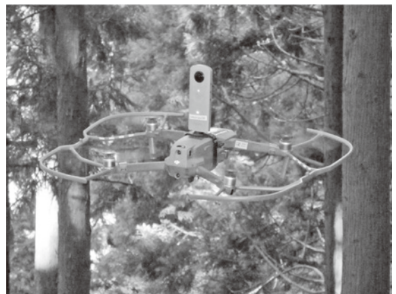
図3 全天球カメラを取り付けて林内を飛行する小型 UAV（メーカー非純正のカメラ装着等を行う場合、機体登録情報の変更手続きが必要）
